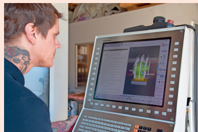
Manuel Kohler: Programmieren der 5-Achs-Hermle-Fräsmaschine.
