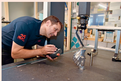
Martin Broder: Qualitätskontrolle im Tausendstel-Millimeterbereich mit der 3D-Messmaschine.
