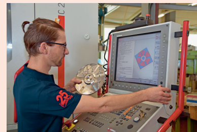
Jürg Stoop: Kontrolle eines Werkstücks aus der 5-Achs-Hermle-Fräsmaschine.
