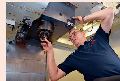
Carlos Da Silva: Vorbereitung der CNC-Fräse für den nächsten Auftrag.
